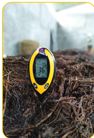
Hình 6. Kiểm tra các tiêu chí giám sát đồng ủ trực tiếp bằng máy đo chuyên dụng
